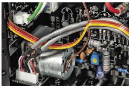
Regulator głośności bez innowacji, ale porządny potencjometr to wciąż rozwiązanie dobre wygodne.
