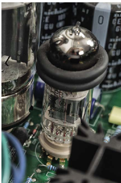
Na lampach 6H30 założono pierścienie tłumiące drgania
